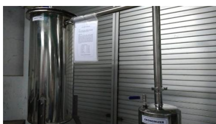
Gambar 10 Tangki Nira Kapasitas 100 Liter dan Economizer
