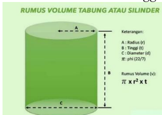
Gambar 12 Cara menghitung volume tabung atau silinder
